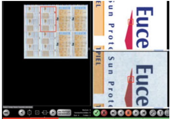
DensiTronic PDF détecte la moindre divergence dans l'image imprimée et constitue ainsi un excellent outil pour le management de la qualité en continu
