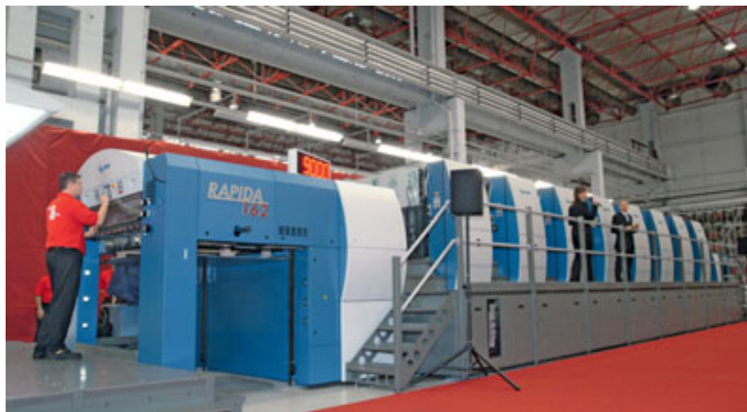
Les deux feuilles de 64 pages pour un beau livre de cuisine ont été imprimées en 4/4 sur la Rapida 162a huit couleurs, à une vitesse de 9000 feuilles/h
