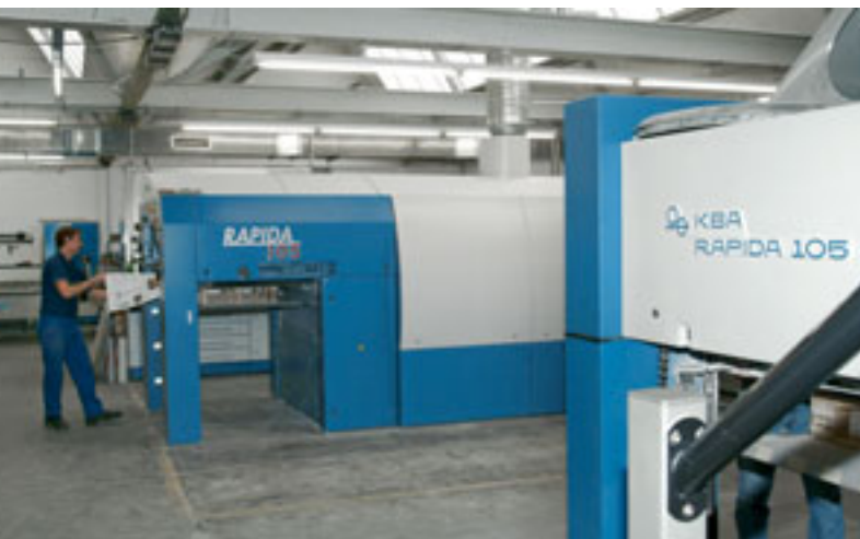
La Rapida 105, rentrée il y a sept ans (devant à droite), et la nouvelle presse 18 000 f/h avec changement des plaques simultanément par DriveTronic SPC
