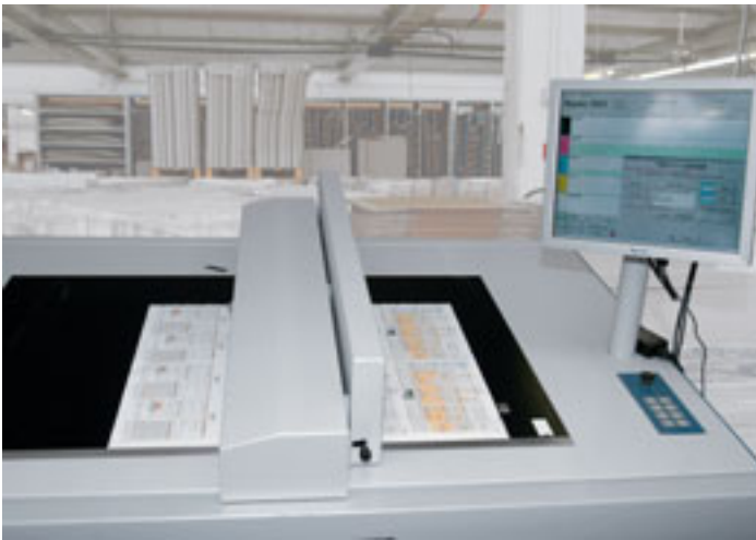
Sur le système de mesure et de régulation DensiTronic professionnel est installée la caméra linéaire haute résolution assurant l'analyse de la feuille imprimée ; un ordinateur très puissant compare le résultat avec le PDF original
