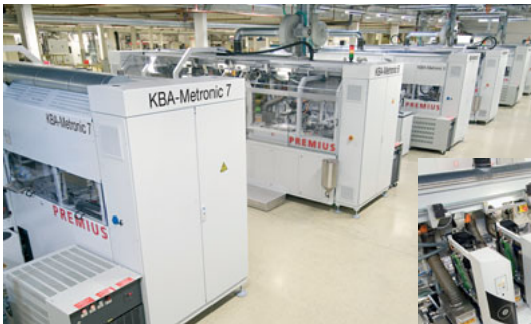
Chacune des presses Premium installées chez Cinram peut imprimer jusqu'à 7200 disques par heure
