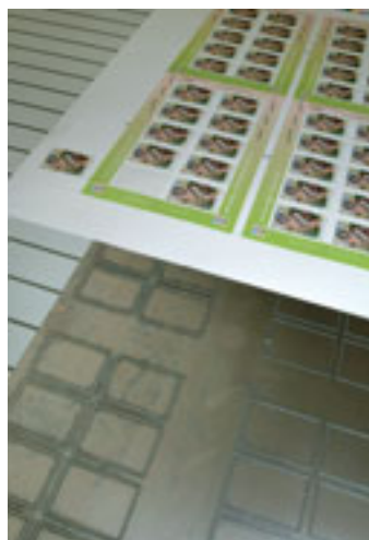
Matrice de découpe et feuille imprimée : des timbres en cours de fabrication chez Elsholz
