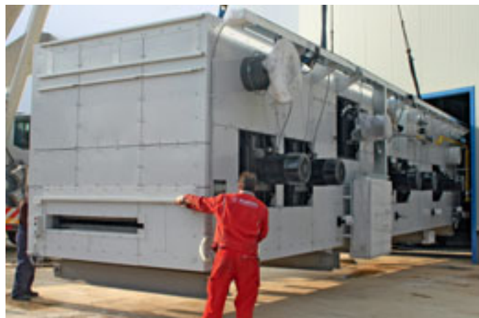
Un travail de précision : mise en place dans l'atelier des sécheurs Vits, mesurant chacun 13,6 mètres de long et pesant 34 tonnes
