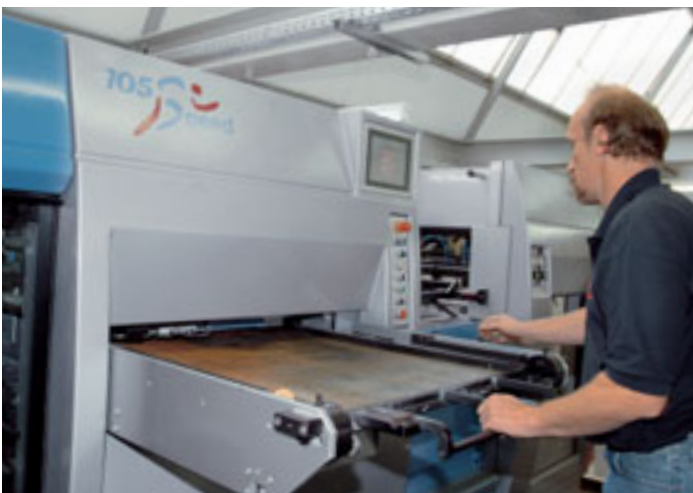
Harald Hartmann remplace la matrice de l'une des deux platines de découpe
