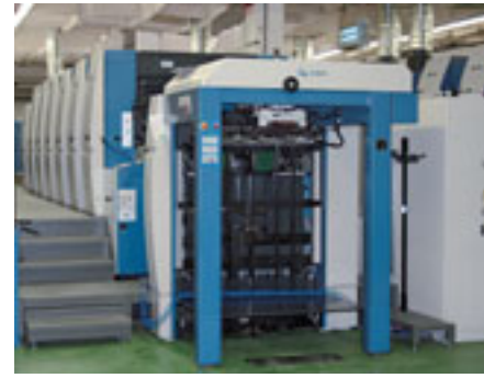
Le rehaussement de 375 mm de la machine est particulièrement visible au niveau du margeur
