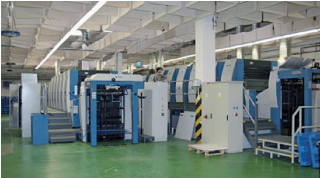
Le rehaussement de 375 mm de la machine est particulièrement visible au niveau du margeur
