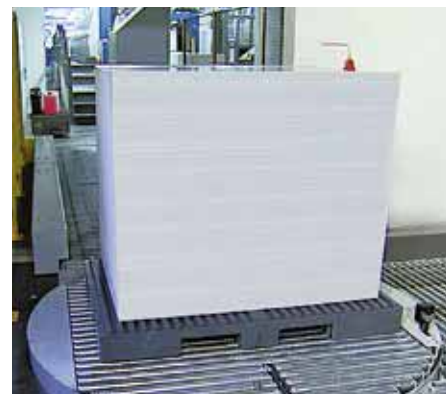
3. Plaque tournante permettant le changement de direction des palettes. En cas de différences de niveau du sol, un élévateur peut être prévu
